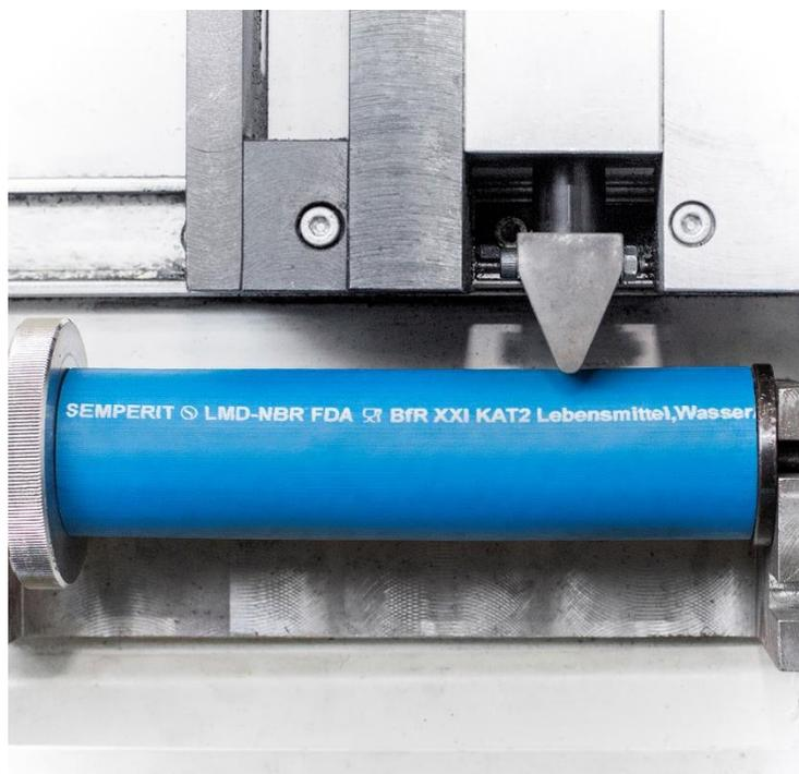
Die Abriebsprüfung des LMD NBR im Semperit Labor zeigte aktuell geringste Materialverschleißwerte seiner Klasse
